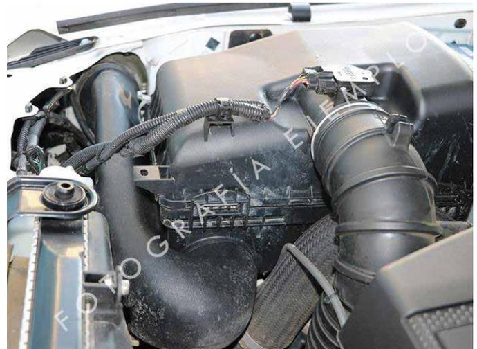
DETALLE CONEXIÓN SNORKEL CON CAJA DE FILTRO
