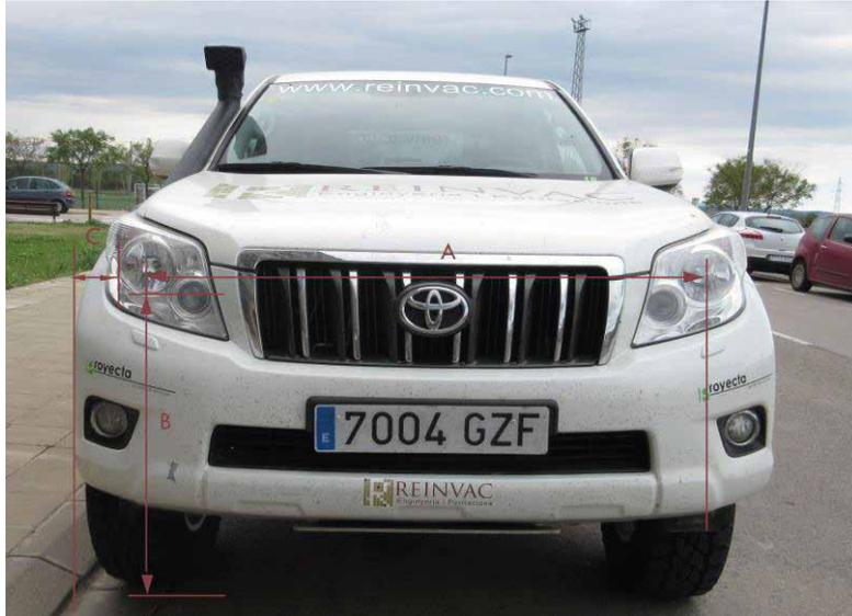
A: Distancia entre proyectores/ B: Distancia entre proyector y suelo / C: Distancia de foco a ancho máx. del vehículo
