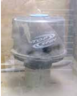
Imagen del prefiltro TopSpin del laboratorio de verificación de diseño de Donaldson después de 20 horas de carga ISO de polvo fino con dos veces de visibilidad cero.
