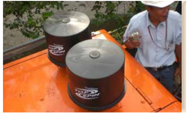
Los Pre-filtros TopSpin™ son autoeyectables y no requieren servicio. TopSpin doble aplicado a un vehículo todo terreno.
